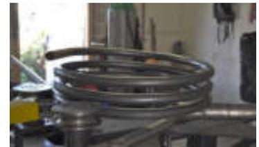
4. Fertigung der Wärmetauscher
